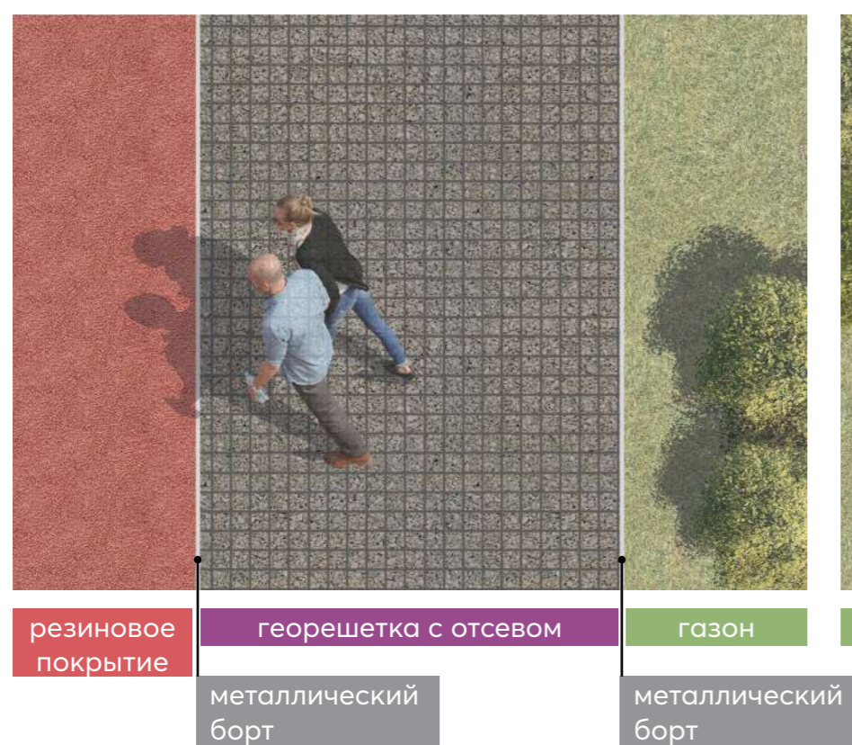
Сопряжение георешетки и стабилизированного отсева с газоном и резиновым покрытием
