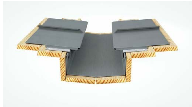
Устройство водосборного желоба на фальцевой кровле. Ендова
