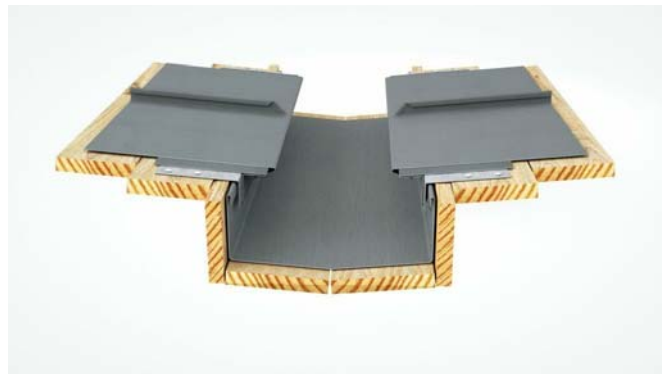
Устройство водосборного желоба на фальцевой кровле. Ендова
