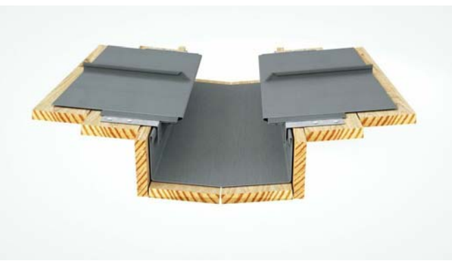
Устройство водосборного желоба на фальцевой кровле. Ендова
